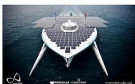
Planet Solar, le navire "tout électrique" à énergie solaire, peut transporter 60 passagers à 5 nœuds. Il compte 512m<sup>2</sup> de panneaux solaires, et est en ce moment à Paris.
